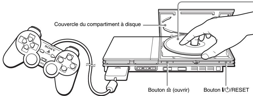
Insérez le disque dans la console, l'étiquette orientée vers le haut.
